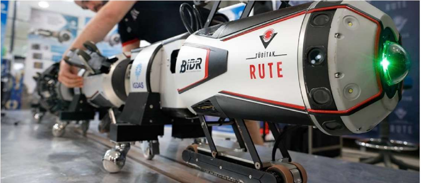
TÜBİTAK RUTE tarafından geliştirilen doğalgaz borularındaki gaz kaçaqlarını tespit eden Robot Göz
